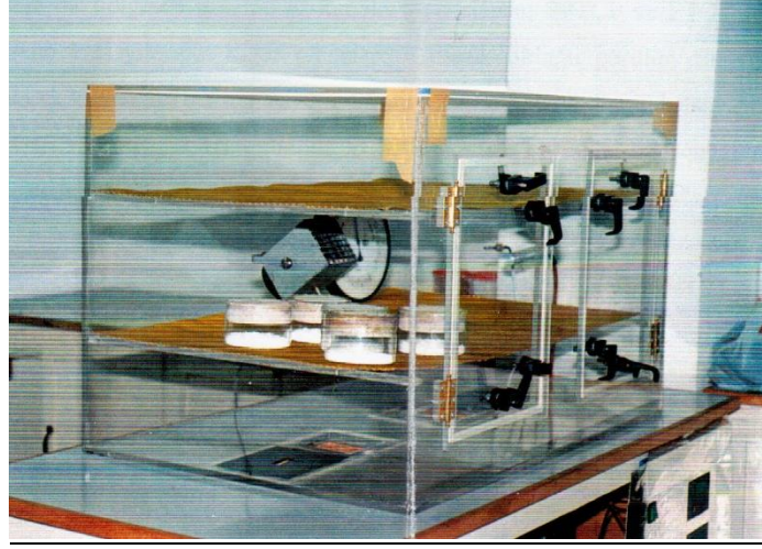
Resim 19. Buhar difüzyon direnç katsayısının bulunması için hazırlanan deney düzeneği
