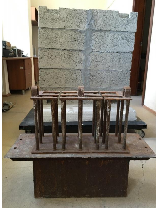
Resim 33. Üretilen havalandırmalı çift kabuklu dış duvar briketi ve kalıbı
