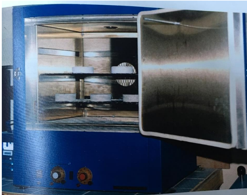
Resim 26. Örneklerin etüvde kurutulması
