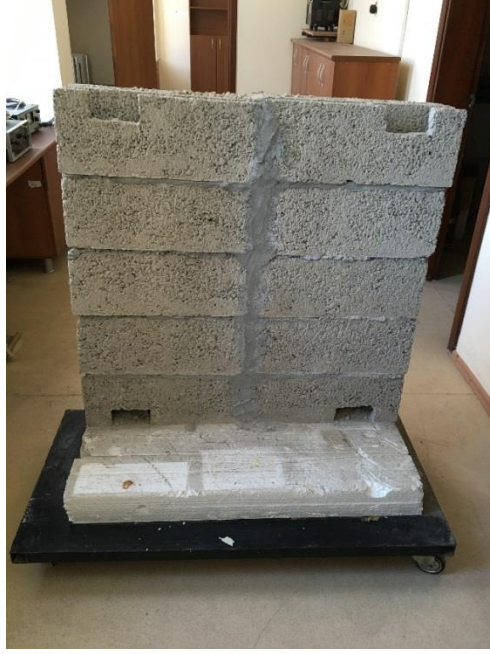
Resim 33. Üretilen havalandırmalı çift kabuklu dış duvar briketi
