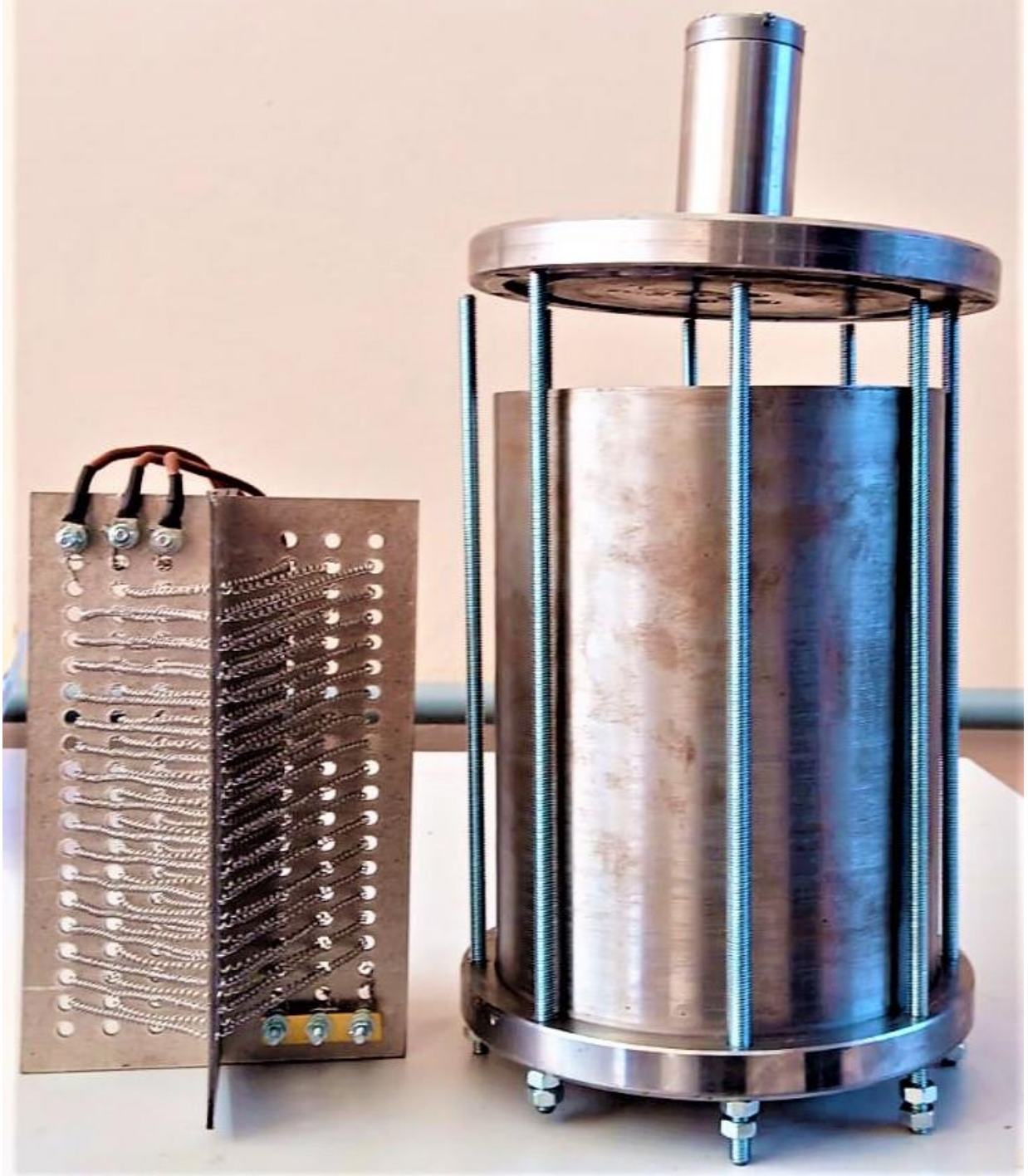
Şekil 3.27 Isıtma odası ve ısıtıcı.
