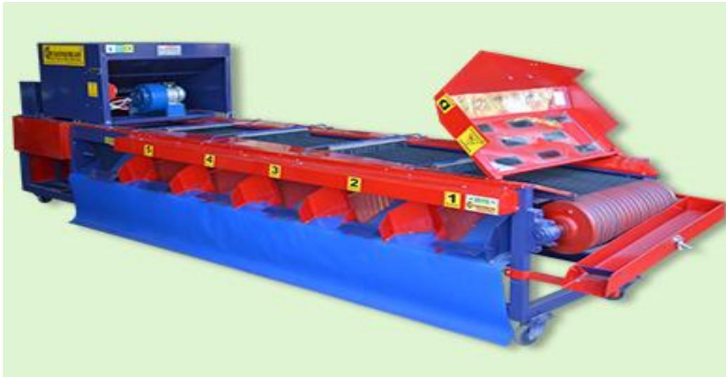
Şekil 1.1. Sargınlar Elek Sistemi
