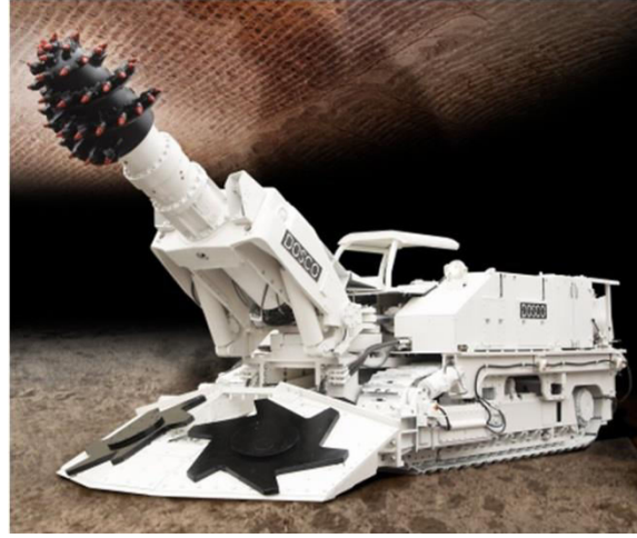
Şekil 8. Kollu galeri açma makinası
